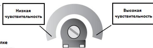
Для увеличения чувствительности поверните винт регулировки по часовой стрелке (двигатель остановится легче) и в другую сторону для уменьшения чувствительности.
