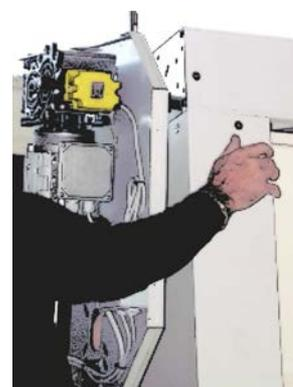
3.8.6 Крепление двигателя к боковой части ворот должно быть сделано с помощью 4-х поставленных винтов M10x30, используйте 4 отверстия фланца.
