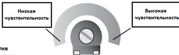
Для увеличения чувствительности поверните винт регулировки по часовой стрелке (двигатель остановится легче) и в другую сторону для уменьшения чувствительности.
