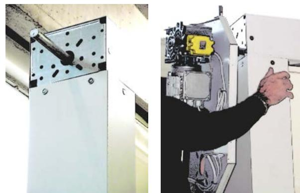
3.8.6 Крепление двигателя к боковой части ворот должно быть сделано с помощью 4-х поставленных винтов M10x30, используйте 4 отверстия фланца.
